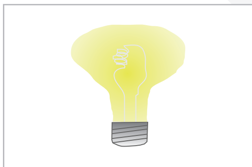
Figura 6. Esquema d'una làmpada d'incandescència
